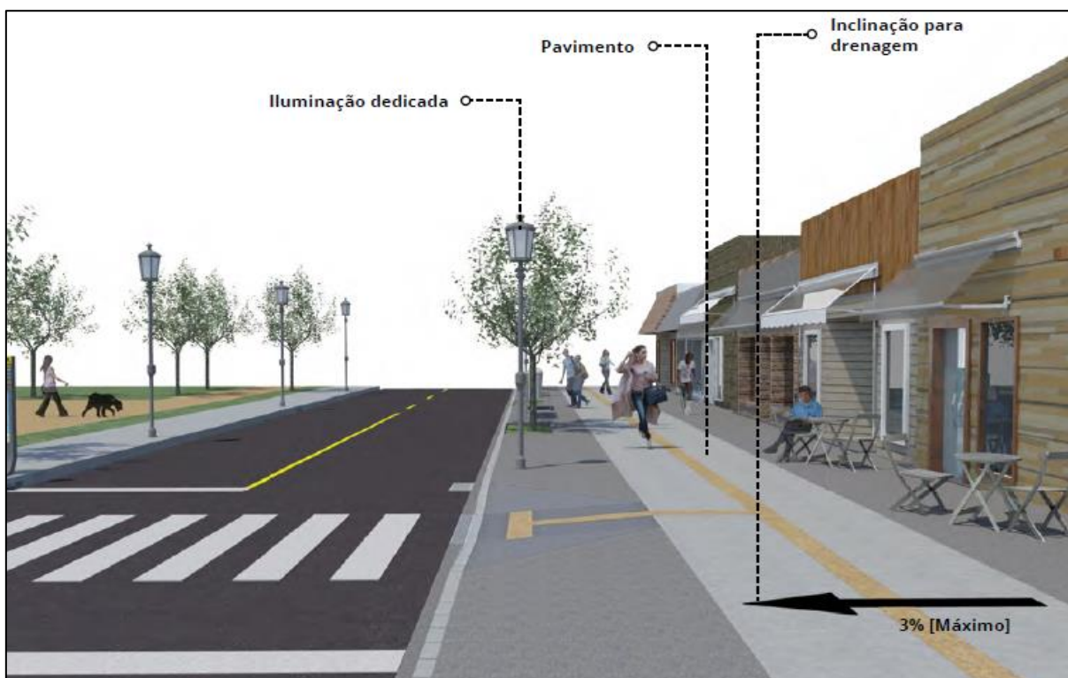
Figura 16 – Inclinação para drenagem e iluminação dedicada
