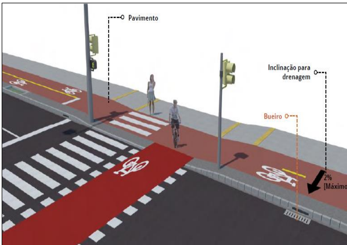
Figura 84 – Pavimento e inclinação para drenagem
