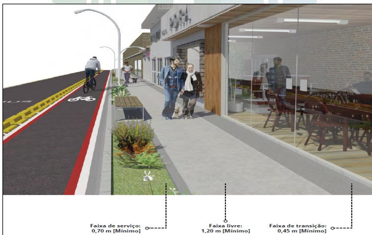
Figura 15 – Dimensões mínimas de calçadas
