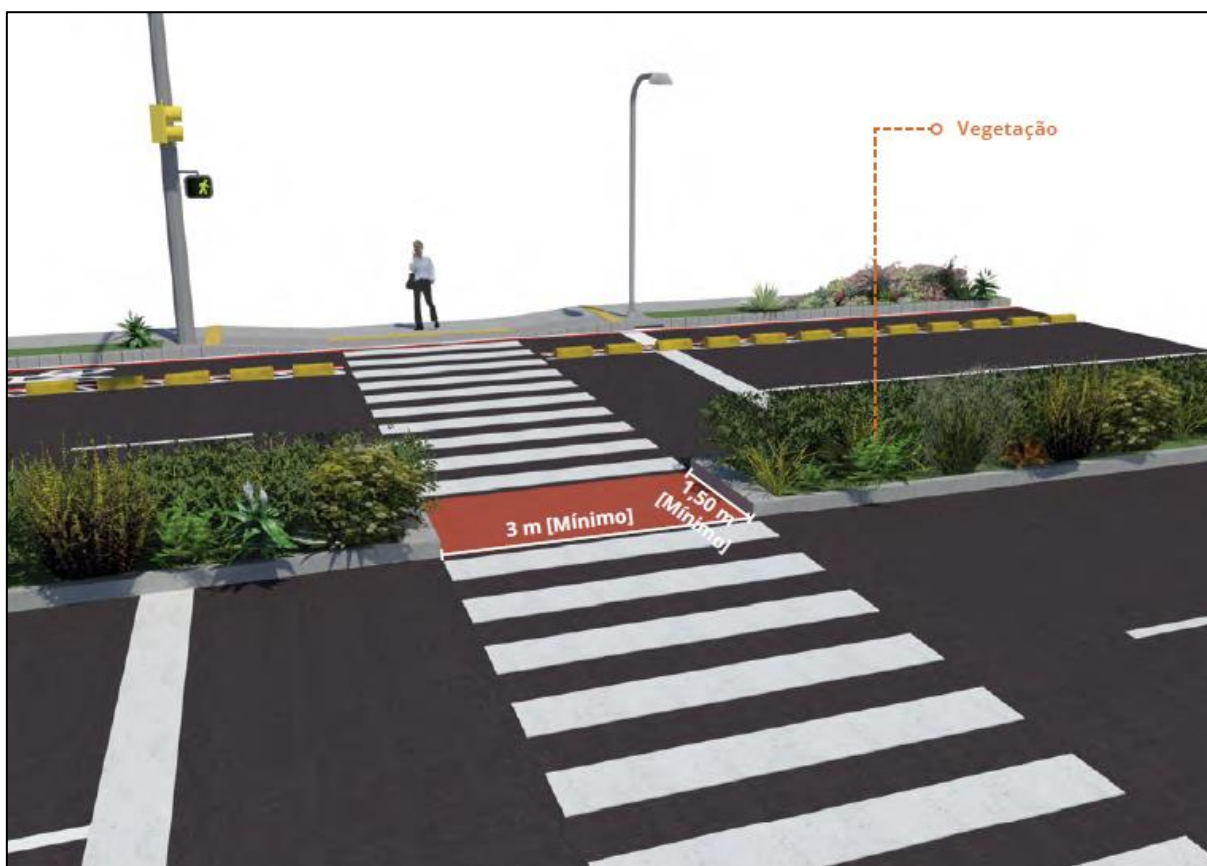
Figura 97 – Dimensões da ilha de refúgio
